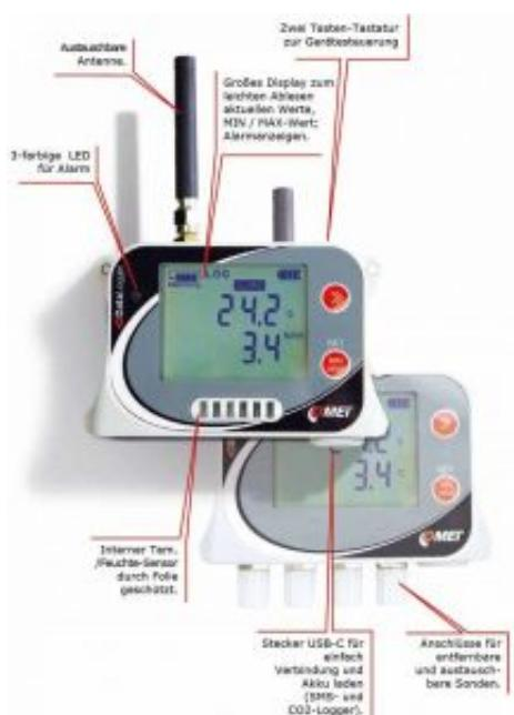
Batteriebetriebene GSM Datenlogger
