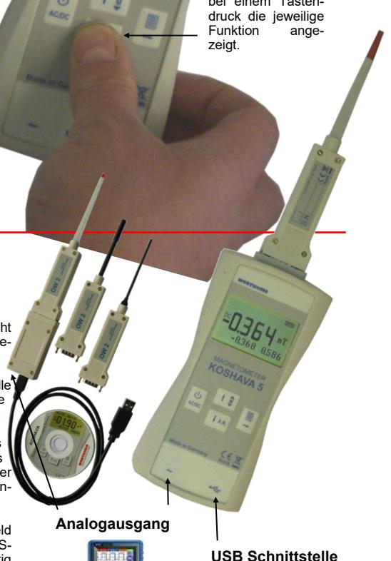
Analogausgang: ±800 mV für vollen Bereich bis max10 KHz nicht korrigiert.
