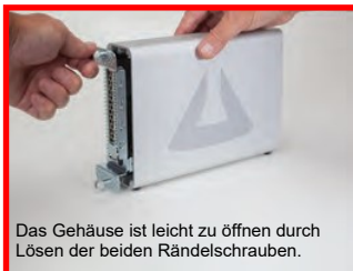
Leicht, schnell und benutzerfreundlich lässt sich die PCIe Karte installieren
