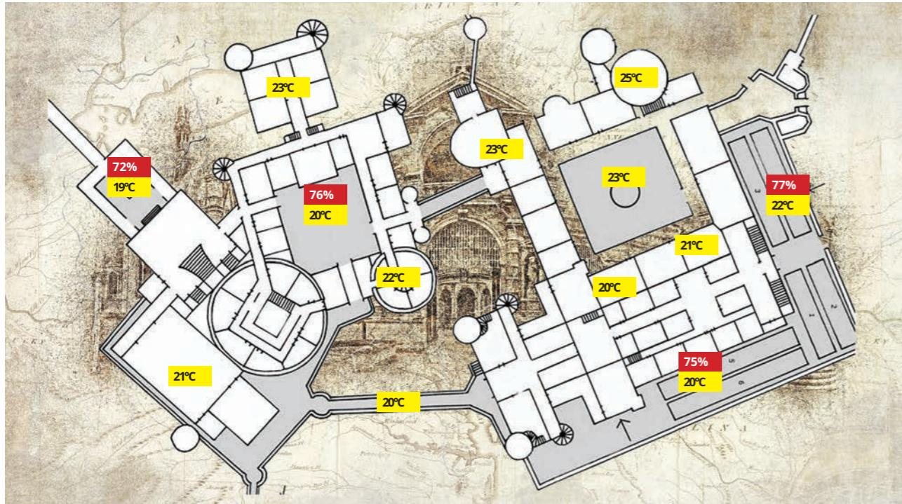
In der COMET Cloud können Sie die Messungen von Temperatur, relativer Luftfeuchtigkeit, Taupunkt und Luftdruck einsehen.
